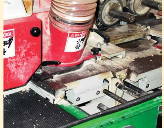
Die Rohleisten werden zu acht unterschiedlichen Standard-Profilen gefräßt.
