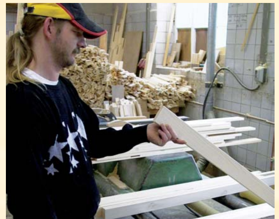
In der Endkontrolle werden noch einmal alle Leisten überprüft bevor sie ausgeliefert oder zum Keilrahmen zusammengebaut werden.
